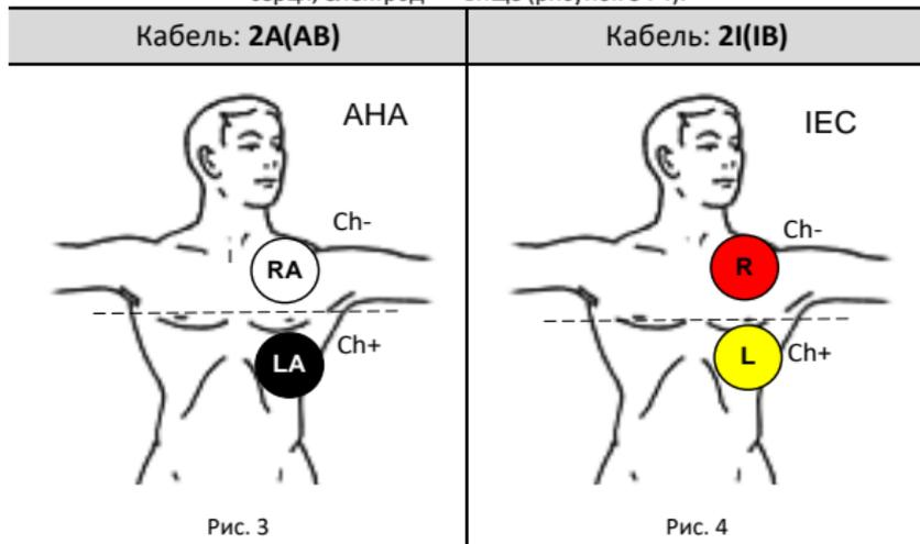
Монополярна схема накладання для 3-х електродів:
