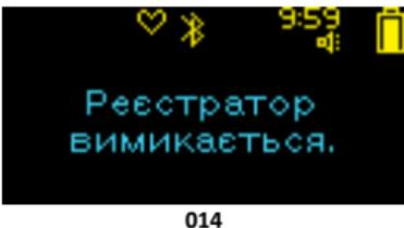
! Реєстратор вимикається «по кнопці», незалежно від режиму, в якому він знаходитьться, за винятком режиму «Оновлення ПЗ».
